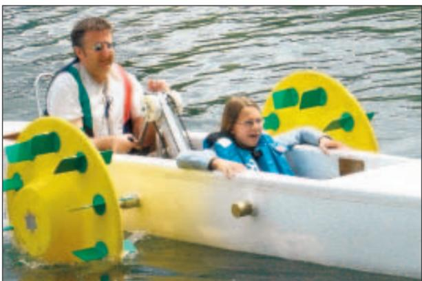
Das Paraboat: Dank Handkurbelantrieb verschwinden die Unterschiede zwischen Gehbehinderten und Fussgängern.
